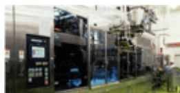
ESL 充填機（クリーンルーム）
