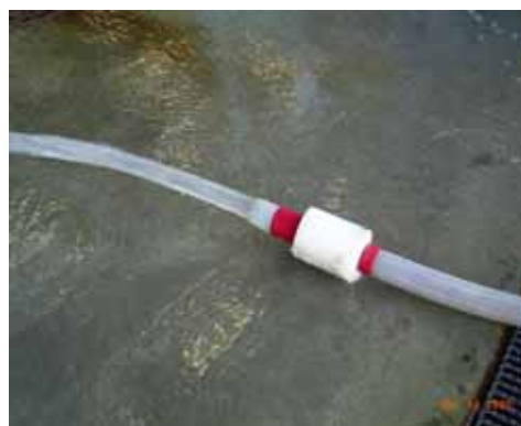
ホース先端を面に接触させないための工夫。床面からの汚染を防止する。
